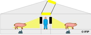
3. Charpente en bipente et puits de lumière au niveau du faîtage
