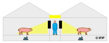
2. Charpente en double bipente et puits de lumière au niveau du chéneau
